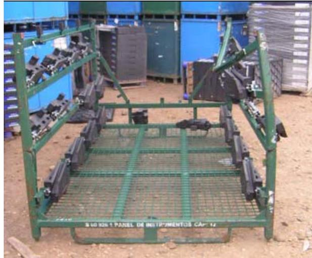
**Figura 6. Contenedor con pilar y lateral doblados**
