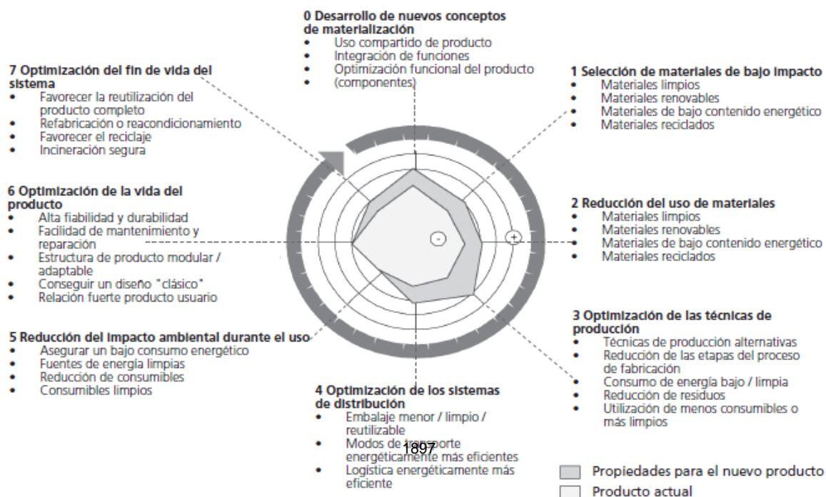
Figura 1. Representación grafica de la Rueda de las Estrategias del Ecodiseño propuestos por Van Hemel (1998).
