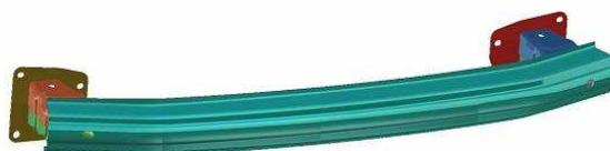
**Figura 2: Detalle mostrando la ubicación de la traviesa parachoques posterior en el coche**
