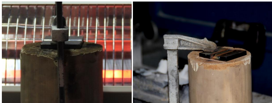
Figura 3: Colocación y amarre de las piezas sobre la superficie refractaria con el calentador de fondo
