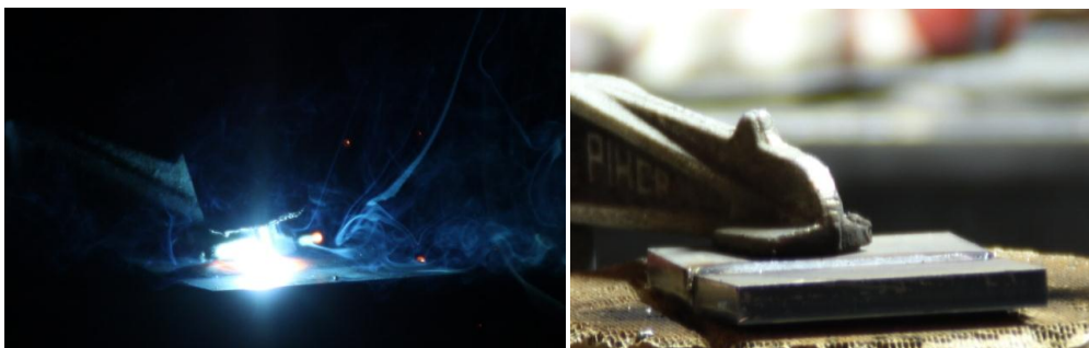
Figura 4: Proceso de soldadura y muestra del efecto de la contracción térmica
