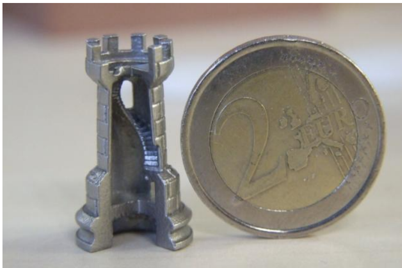
Figura 2: Geometría interna compleja en la escalera helicoidal interna de una torre del tamaño de una moneda
