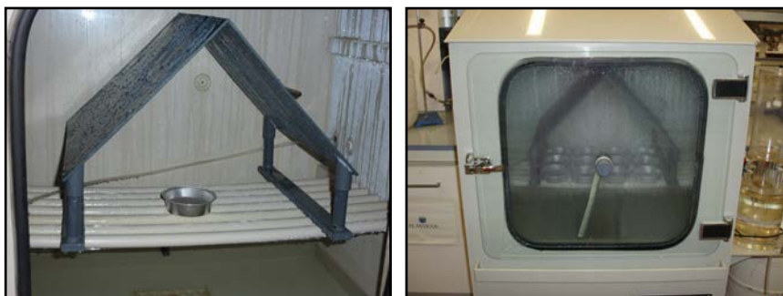
Figura 6: Sistema protector de PVC en el interior de la cámara climática (izquierda) y cámara en funcionamiento (derecha)
