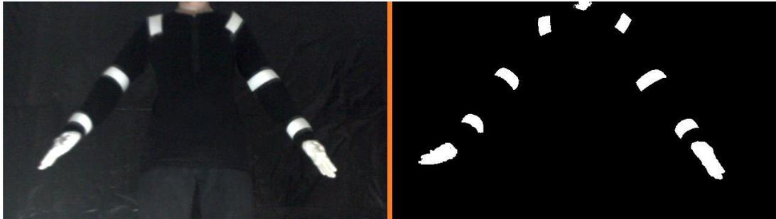
Por otro lado, se realizó un segundo experimento donde se reprodujo el movimiento articulado en 2D del hemisferio superior del cuerpo humano a través del software Matlab ®. Para ello se consideraron varios marcadores pasivos situados sobre los dos brazos con el fin de reproducir el movimiento natural. Inicialmente fue necesario binarizar y segmentar las imágenes de los marcadores pasivos (Figura 7) para posteriormente reproducir el movimiento a través de un modelo virtual (Figura 8).
