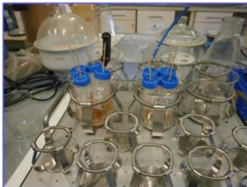
Figura 3: Sistema de reacción con agitación orbital
