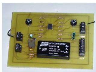
Figura 5: Placa alimentación de dispositivos y adaptadora de señal.
