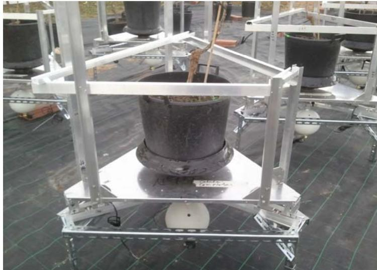
Junto con el lisímetro se instaló un datalogger para registrar los datos de peso obtenidos del lisímetro, así como el peso del drenaje de agua experimentado por la maceta y recogido por un depósito instalado para tal fin. El modelo de datalogger escogido fue el CR1000, de Campbell Scientific.
