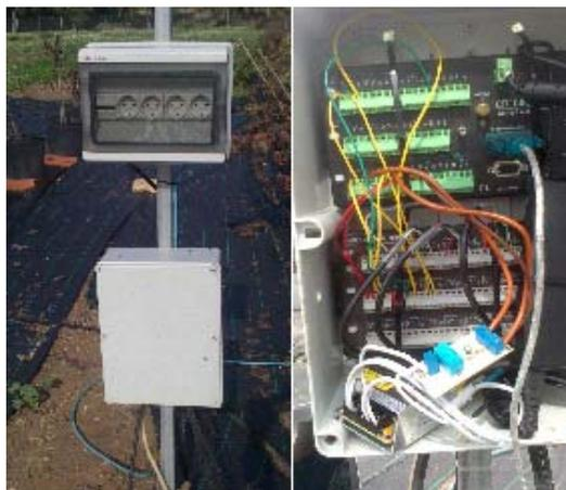
El datalogger estuvo guardado en una caja sellada o arqueta en la que se almacenó junto al multiplexor, la fuente de alimentación y el circuito de potencia encargado de activar las electroválvulas. Dicha caja estuvo sujeta a un poste de hierro forjado, con el que compartió un cuadro eléctrico compuesto por un diferencial y cuatro tomas de fuerza.
