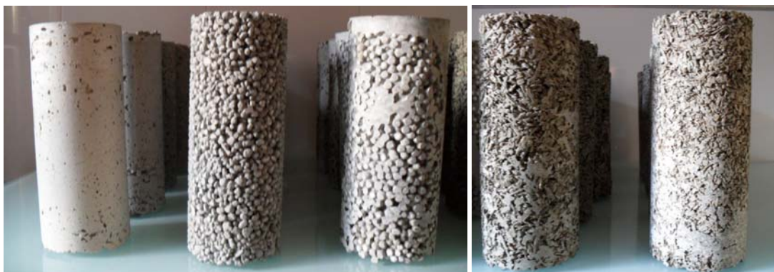
Figura 5: Huecos de aire macroscópicos en las muestras ordenadas de izquierda a derecha: Perlita, Arlita, EPS, Madera larga y Madera corta.
