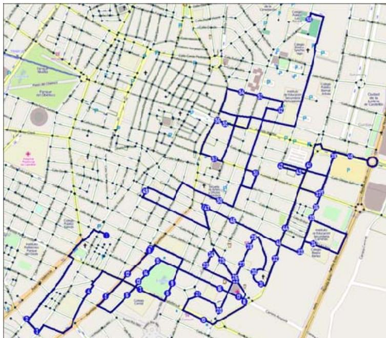
En la figura 7 se muestra la ruta óptima de recogida calculada para un sector nuevo de la ciudad del cual no se tienen datos de referencia. A parte de las restricciones de giros y sentidos de las calles común en todos los casos, la restricción marcada en este caso es que la ruta pase por todos los contenedores existentes en este sector.
